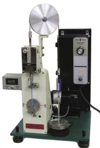
Figura 6 - Equipamento para ensaio de dobramento
