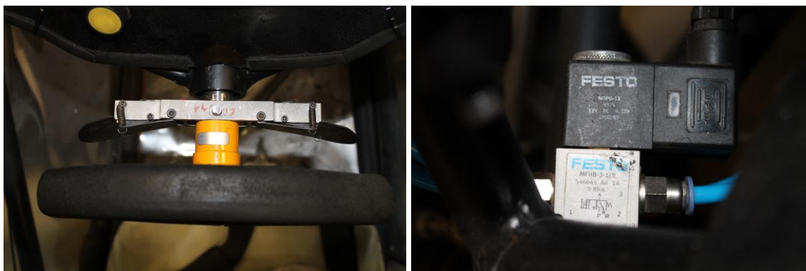
Figura 16 – Borboletas e válvula solenoide para troca de marcha
