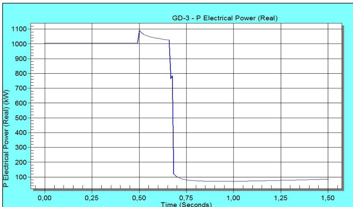
Figura 62: Fluxo de potência no ramo BT-24 (MINI – ZETA) durante o evento de falha (Caso 2)
