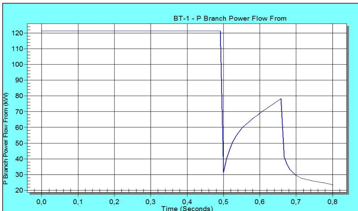
Figura 55: Fluxo de potência no ramo BT-1 (MINI – ALPHA) durante o evento de falha (Caso 1)
