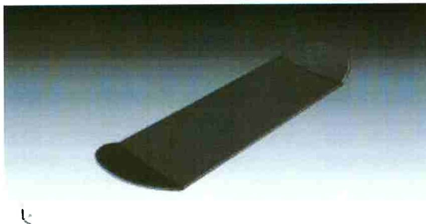
Figura 9 Modelo típico do deck , com kicktail e nose simétricos [14] .
