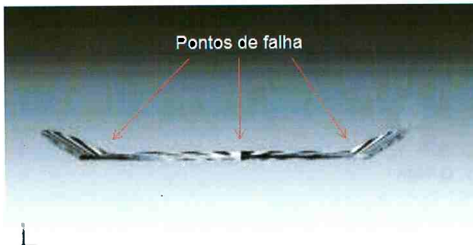
Figura 10 Representação da vista lateral do deck , com pontos de falha assinalados [14] .
