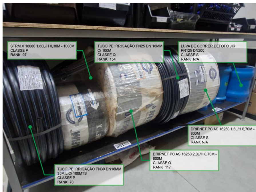
Figura 4.20 – Posicionamento de tubos e luvas
