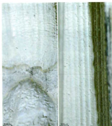
Figura 5.6 – Esq.: Corpo de prova com odiafragma (nó); Dir.: Corpo de prova internó.
