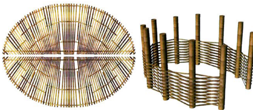
Figura 2.1 – Renderização representativa. Esq.: fibras do falso teto (vista em planta). Dir.: Perspectiva das fibras delimitadoras de espaço.
