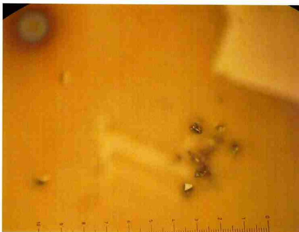
Figura 7: Cacos do molde quebrado.
