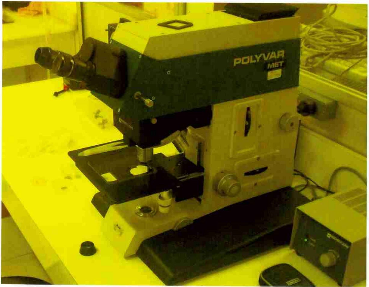
Figura 29: Microscópio óptico com aumento de até 50x
