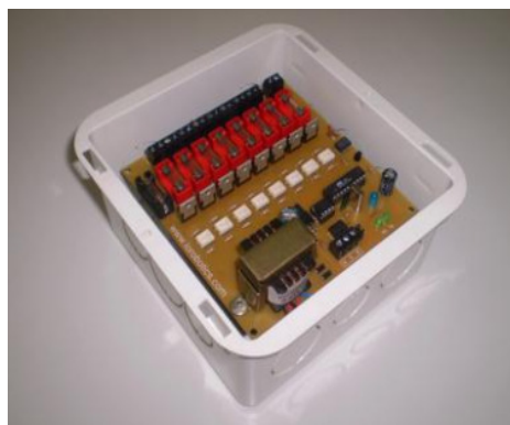
Figura 2 - 8 dimmers digitais para rede Multipoint
