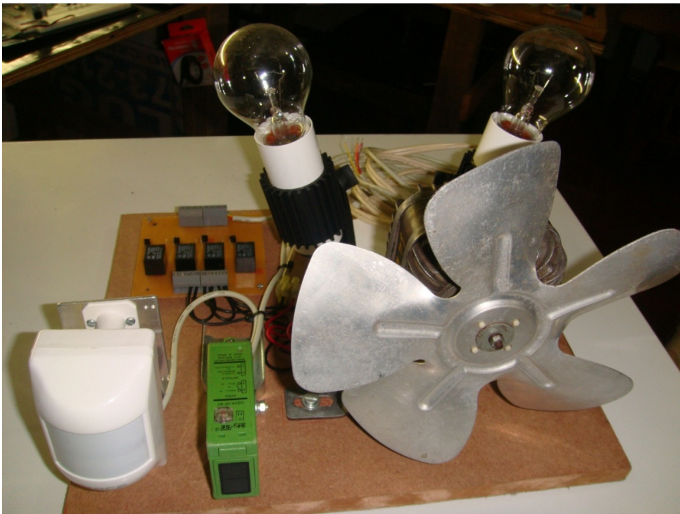
Figura 30 - Montagem das cargas e sensores
