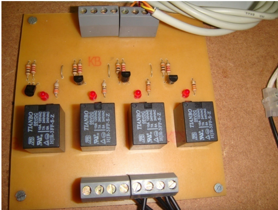
Figura 29 - Detalhe da placa de relês
