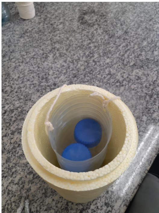
Figura 4: Montagem do processo de banho em Nitrogênio Líquido, usando um sistema de Banho Maria, congelando a base do tubo.
