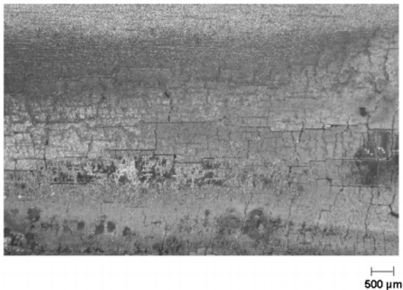
Figura 24- Superfície de aço H13 contendo uma rede de trincas térmicas após ser submetida a 4000 ciclos de aquecimento e resfriamento (700°C) (Buckstegge, Gehricke, & Reichel, 2010).
