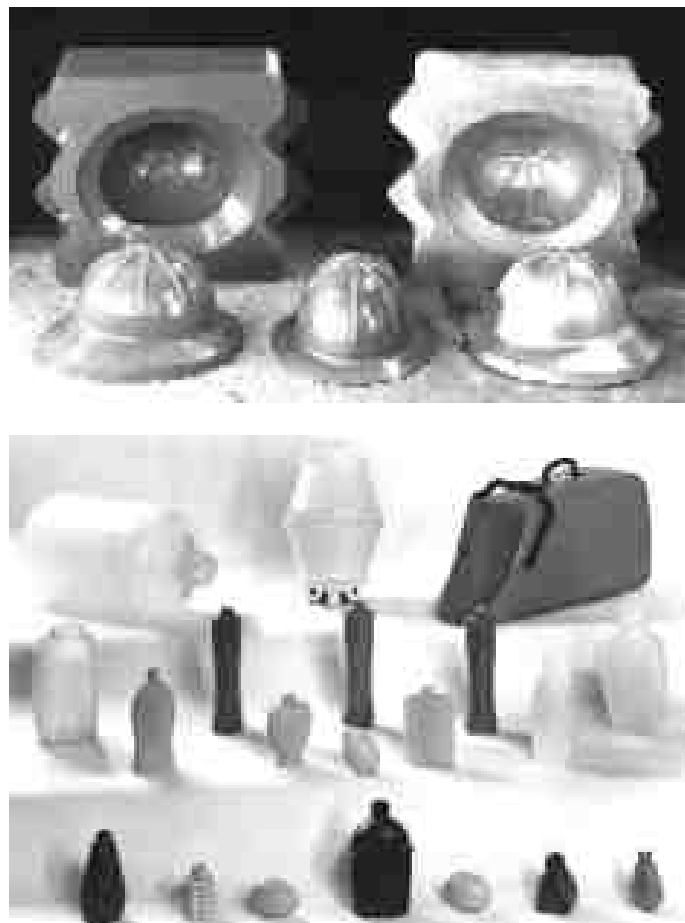
Figura 13 - Moldes fabricados com Zamac 2 ( Kirkosite ) (IZA: International Zinc Association, 2020)
