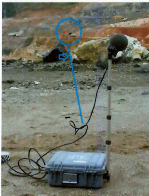
Figura 8 – Exemplo de instalação e alinhamento de um sismógrafo de engenharia.
