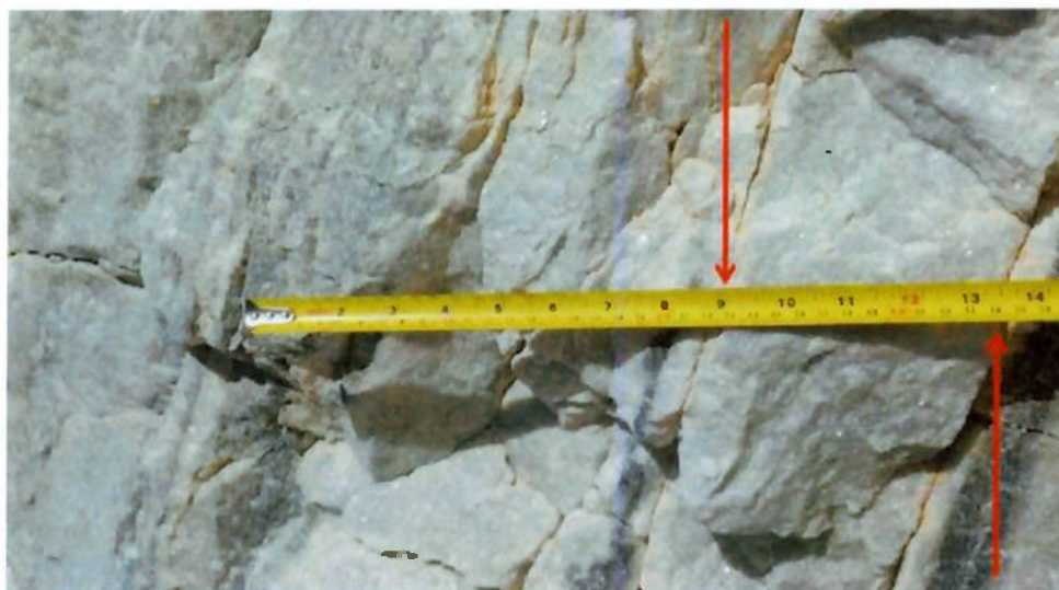
Figura 10 – Exemplo de medição da distância entre duas fraturas de uma mesma família.
