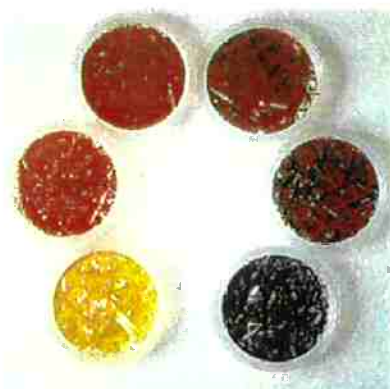
Figura 7-8 Cores obtidas por cristais mistos de CdS – CdSe
