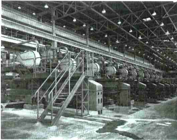
Figura 5-5 Fotografia do esmerilhamento geminado de uma fita de vidro plano com 300 cm de largura. São visíveis somente os esmerilhamentos de topo. A folha de vidro é apenas perceptível no fundo, à esquerda.
