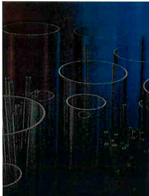
Figura 2-11 Tubos de vidro: permitem a confecção de termômetros e a execução de ensaios com gases e líquidos
