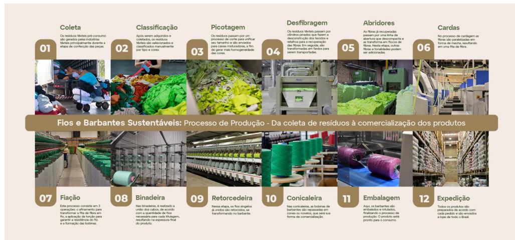
Figura 12: Empresa C: etapas do processo produtivo
