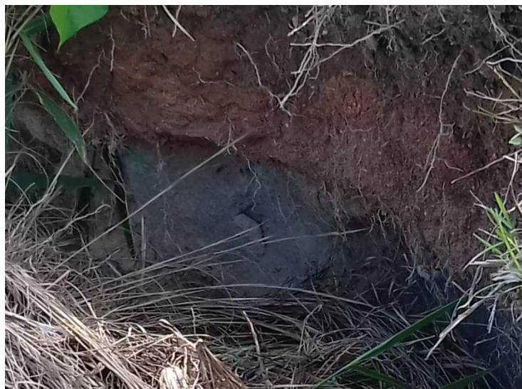
Figura 24 - Imagem que permite visualizar bem o “aterro” promovido com solo alóctone sobre o Espodossolo (parte inferior da figura). Autor: Alba, 2016
