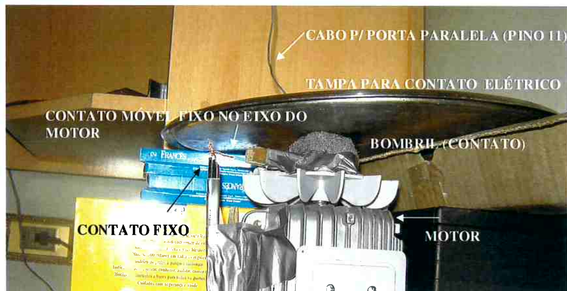
Figura 28 – Funcionamento do sensor
