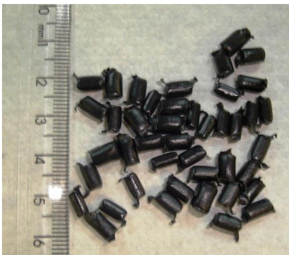
Figura 2 - Meio suporte para imobilização da biomassa - polietileno de baixa densidade.
