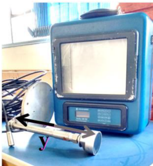
Figura 10 – Ecobatímetro BATHY 500MF e transdutor P/N P01540. Fonte: (BARBOSA, 2019).
