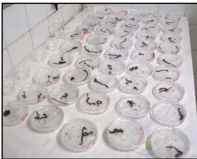
Figura 9- Montagem do ensaio de toxicidade com a minhoca Eisenia andrei
