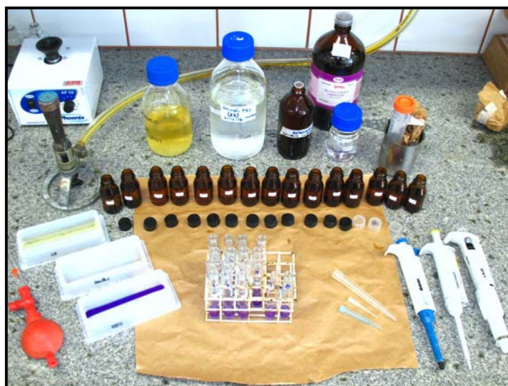
Figura 7- Montagem do ensaio de toxicidade com bactérias
