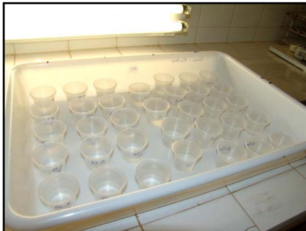
Figura 8- Montagem do ensaio de toxicidade com Daphnia
