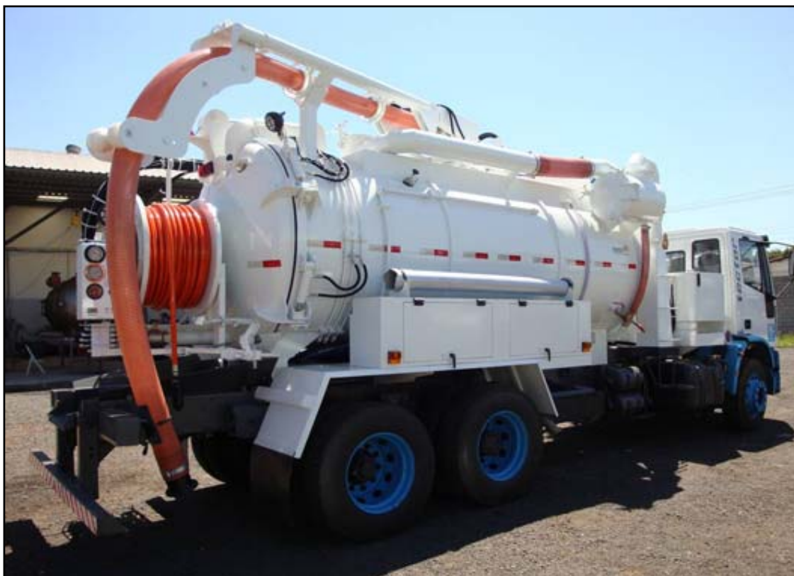
Figura 3 - Equipamento combinado de Hidrojato com bomba de vácuo
