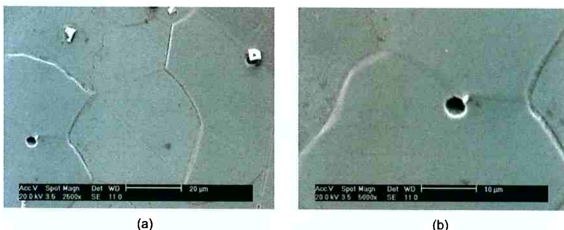
Figura 10. Microestrutura do aço UNS S44400 resultante da prática W. Visualização dos contornos de grãos ferríticos formando degraus e confirmando a ausência da fase rica em cromo nessas regiões. Segundo Botton (31) , as partículas claras são precipitados ricos em titânio, e as cavidades podem ter se originado devido a dissolução da matriz seguida de queda dos precipitados. Aumento: (a) 2500x e (b) 5000x. MEV.
