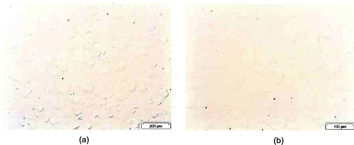
Figura 8. Aspecto do aço UNS S44400 após polimento até 1\mu\text{m} . Estrutura de grãos de ferrita e pequena quantidade de inclusões. Diferença acentuada de desbaste entre os grãos. Sem ataque. Aumento: (a) 50X e (b) 100X. Microscópio óptico.
