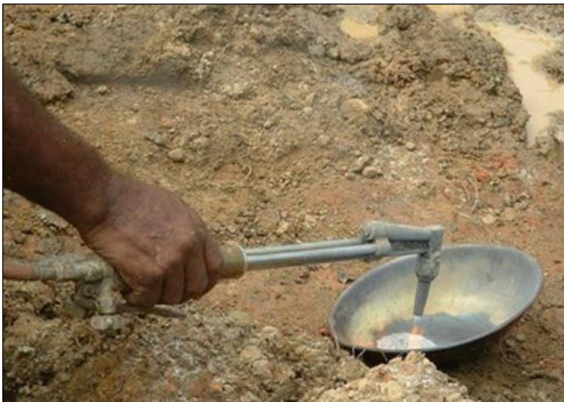
Figura 4 – Foto do processo de queima da amálgama.
