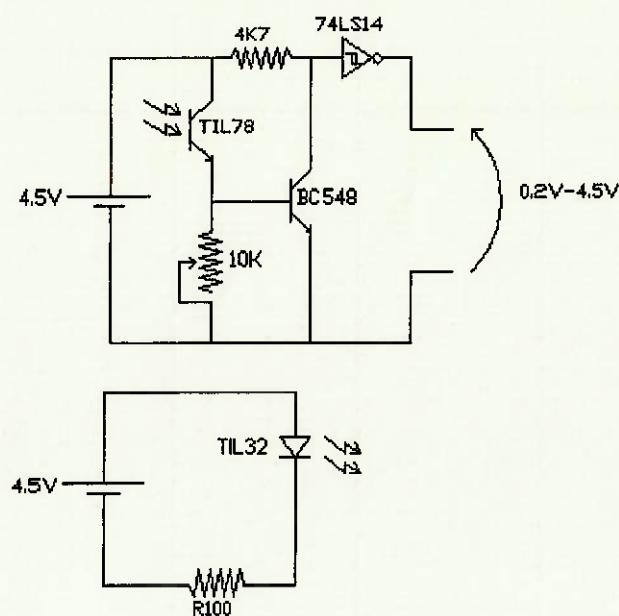
O hardware externo, a ser acoplado na tela do computador portátil, engloba o pedal de controle e a rede de diodos num mesmo circuito. Cada par de componentes ópticos (LED e transistor) envolve o seguinte sub-circuito:
