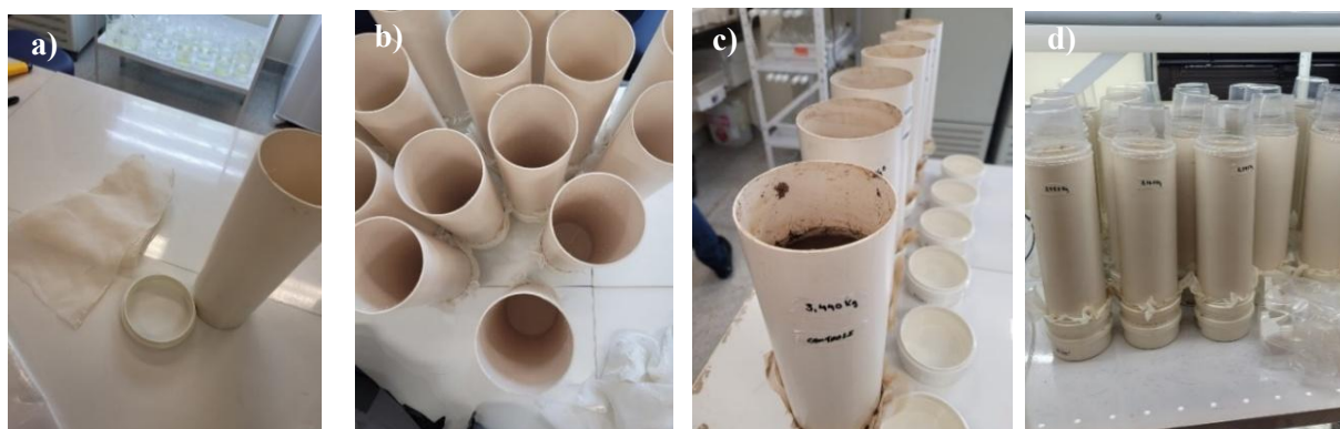
Figura 5 - Desenvolvimento das unidades experimentais, com destaque para (a) os tubos, o fundo usado para a retenção da água e a rede usada para a retenção do solo; (b) as unidades montadas sem a adição do solo (c) e após a adição e (d) as unidades dispostas para condicionamento do biochar
