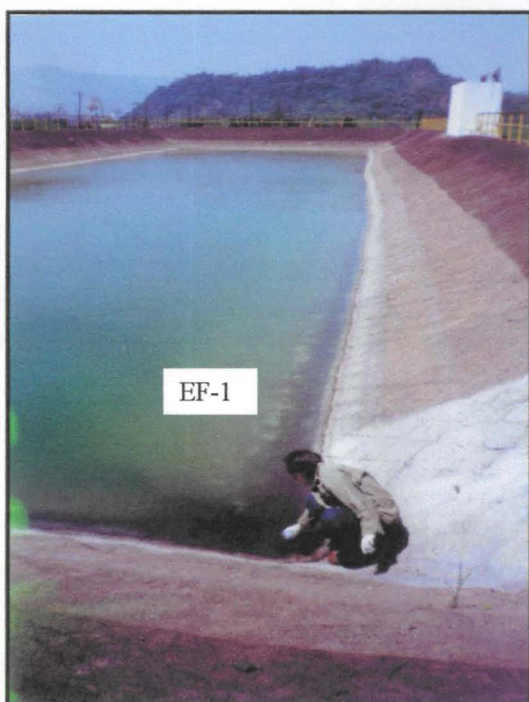
Figura 6 - Coleta da amostra EF-1, no tanque construído para armazenar a água de chuva que percola os resíduos do aterro
