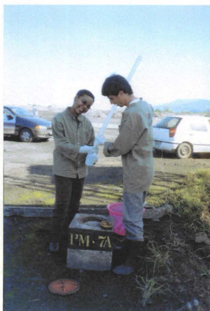
Figura 5 – Coleta de água subterrânea em poço de monitoramento
