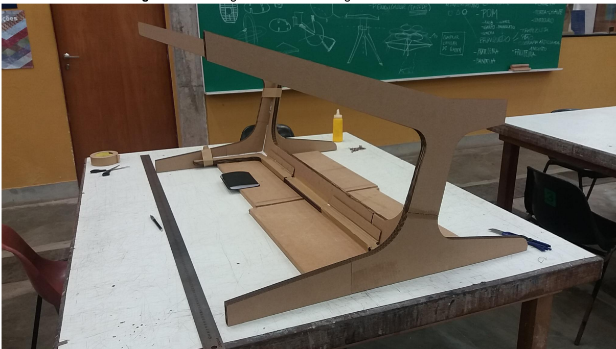
Figura 46 - Montagem do modelo: colagem da estrutura de base.
