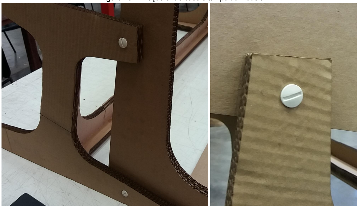
Figura 48 - Fixação entre base e tampo do modelo.
