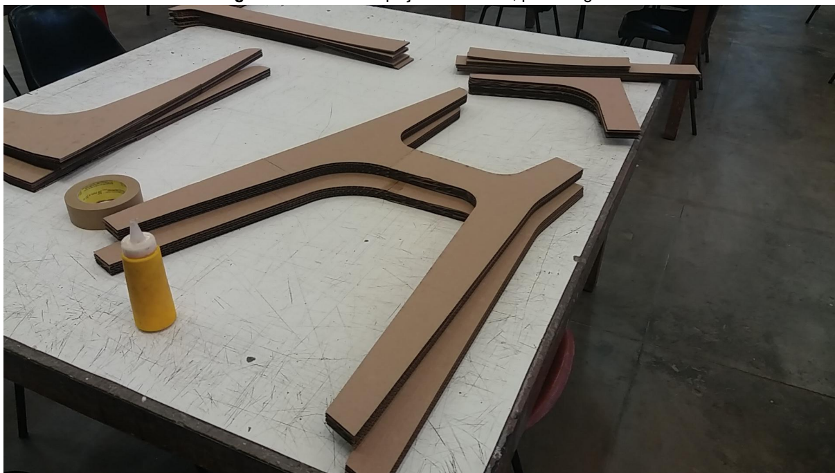
Figura 44 - Fotos das peças do modelo, pós colagem.
