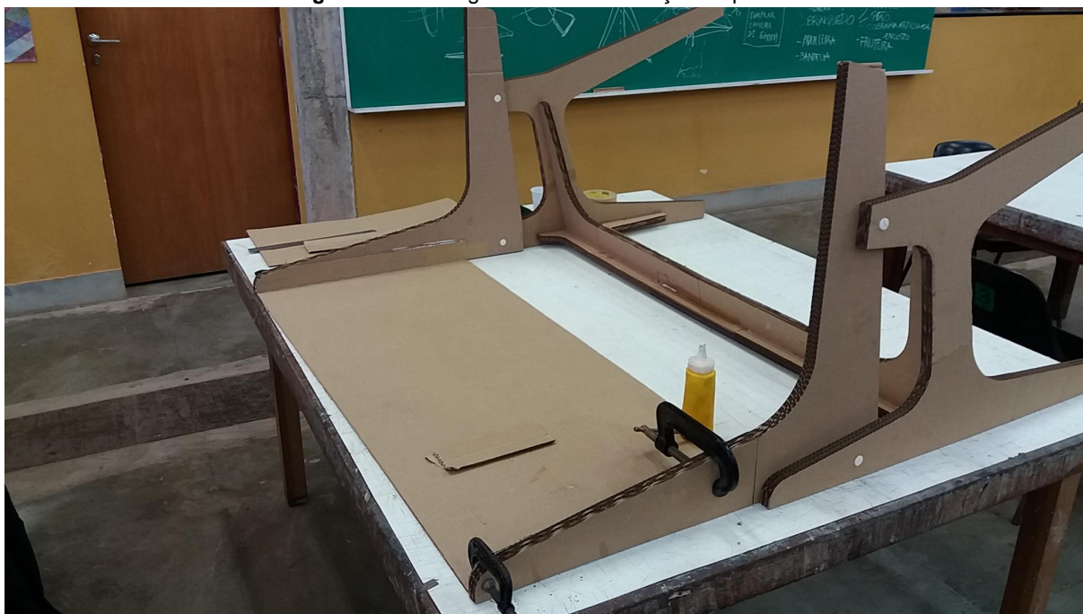
Figura 47 - Montagem do modelo: fixação do painel.
