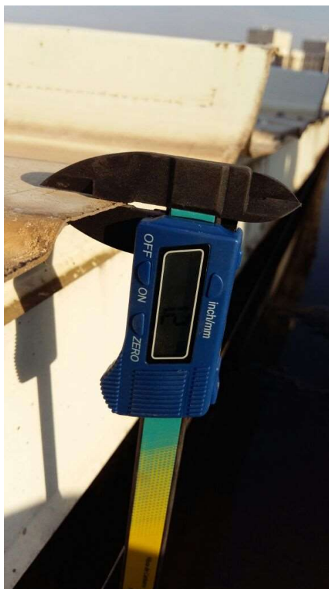
Figura 11 –Medição de espessura do telhado
