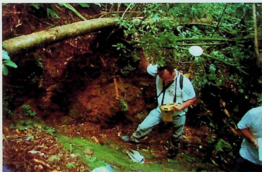
Foto 10 – Leito rochoso de uma das drenagens mostrando em sua margem a espessura em torno de 1,5 m de saprolito e 0,5 m de solo coluvial.
