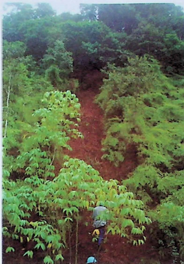
Foto 01 – Cicatriz de escorregamento translacional envolvendo delgada espessura de solo superficial ( < 0,5\text{m} ). Localiza-se no trecho 01 da Estrada de Serviço da Imigrantes (ESI).
