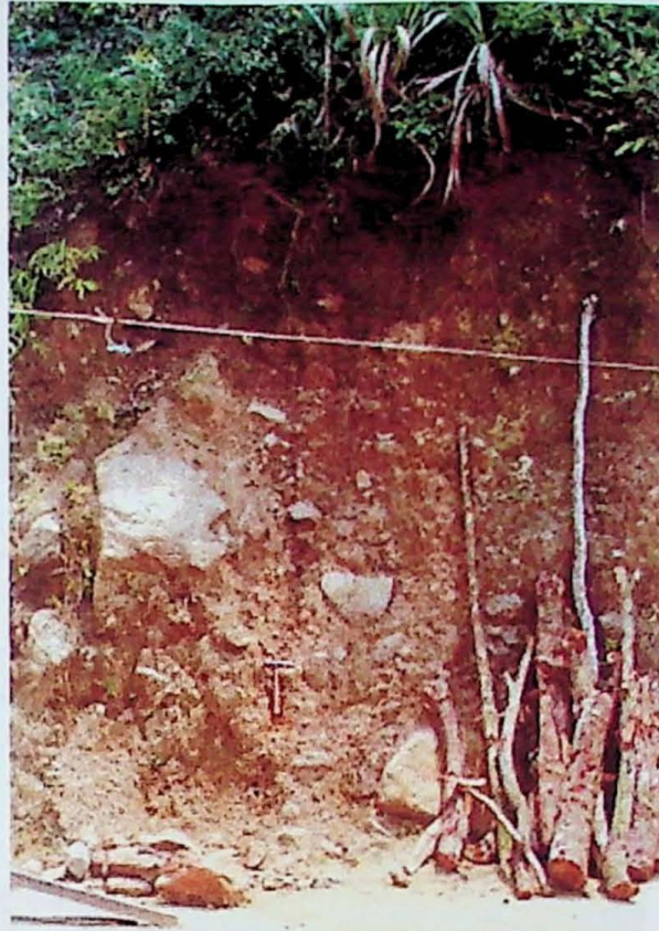
Foto 11 – Talude em depósito de tálus do Bairro Cota 200. Notar a má distribuição granulométrica dos sedimentos e a disposição caótica dos mesmos.
