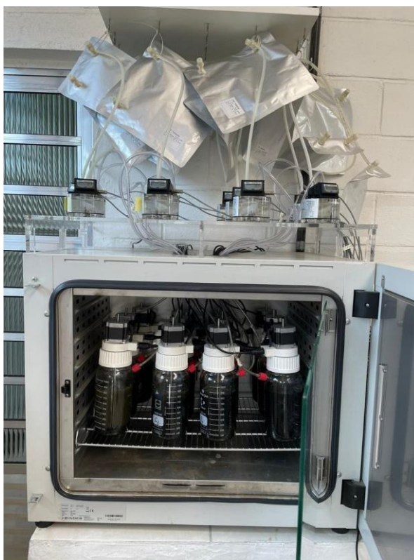
Figura 7: Sistema de Fermentação em Batelada, contendo o reator, carregado com as unidades de reação; e acima, os gasômetros.
