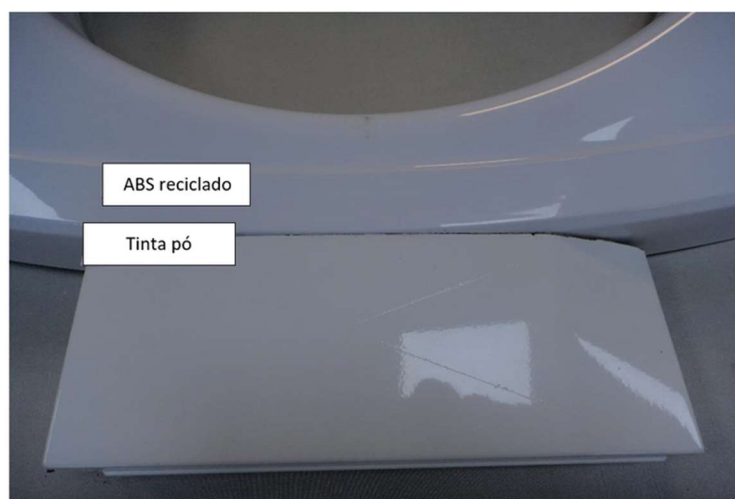
Figura 32 — Comparação de tonalidade entre a peça injetada com ABS reciclado e outro item do produto
