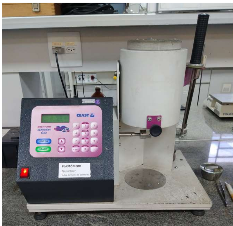
Figura 16 — Plastômetro utilizado para determinar o Índice de Fluidez
