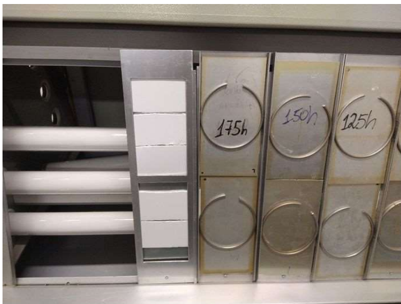
Figura 23 — Amostras de ABS posicionadas para o ensaio QUV-B.
