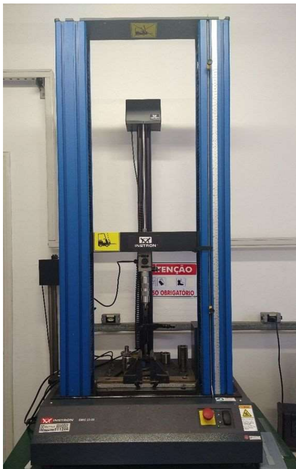
Figura 27 — Aparelho universal EMIC preparado para ensaio de flexão
