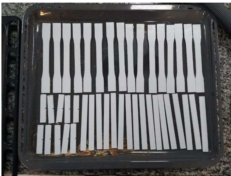
Figura 17 — Bandeja com corpos de prova para teste de envelhecimento
