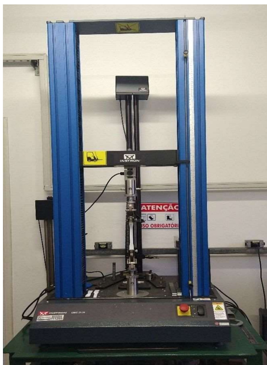
Figura 25 — Aparelho universal EMIC preparado para ensaio de tração
