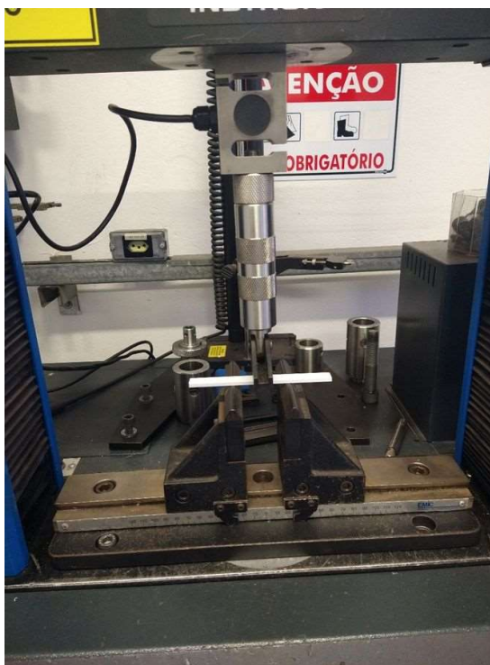
Figura 29 — Corpo de prova de flexão posicionado no Aparelho universal EMIC
