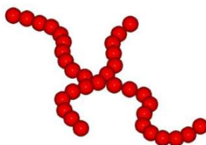
Figura 3 — Exemplo esquemático de um homopolímero
