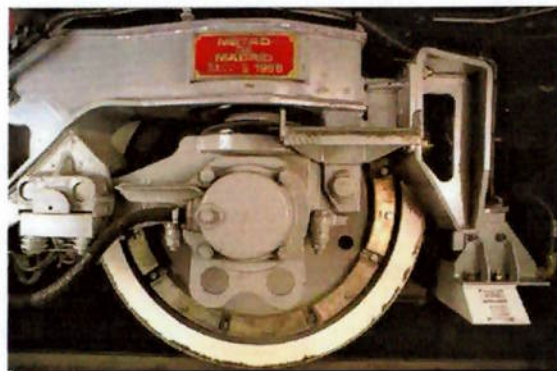
Figura 3.1-Tacômetro instalado na extremidade do eixo
