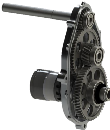
Figura 27 - Representação do interior da caixa de transmissão do protótipo.
