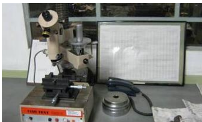
Figura 40 - Microdurômetro utilizado na determinação da microdureza superficial dos componentes.
