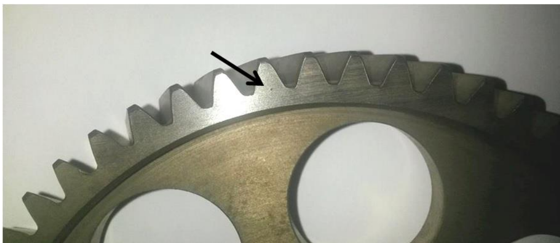
Figura 45 - Ponto de medição de dureza na engrenagem convencional.
