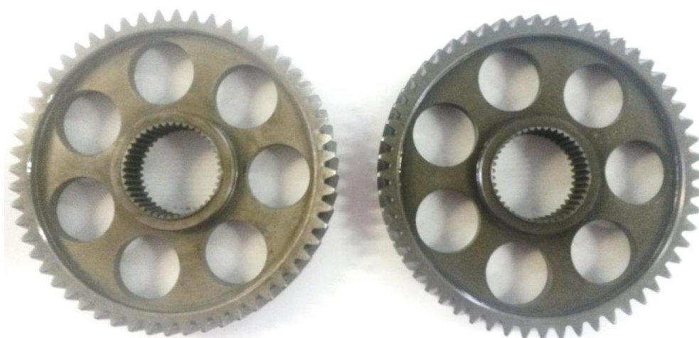
Figura 37 - Engrenagens finalizadas (engrenagem convencional à esquerda e engrenagem sinterizada à direita).
