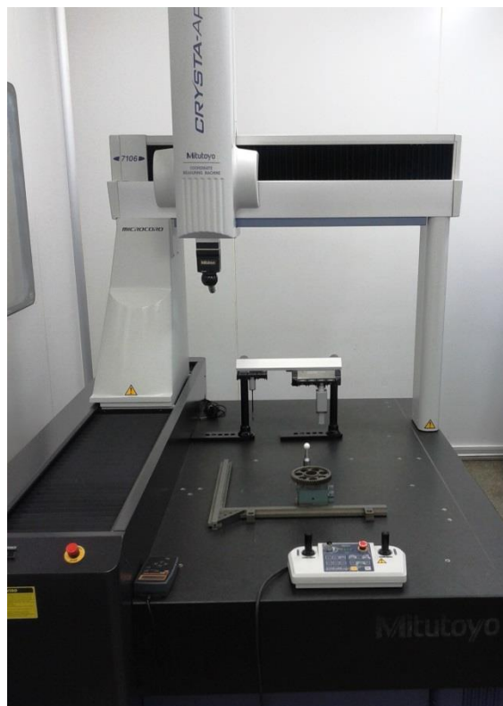
Figura 41 - Máquina de medir coordenadas utilizada na medição do perfil dos dentes das engrenagens.
