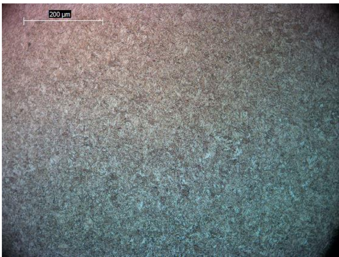
Figura 58 - Análise metalográfica da região do núcleo de um dente da engrenagem snterizada a um aumento de 200x.
