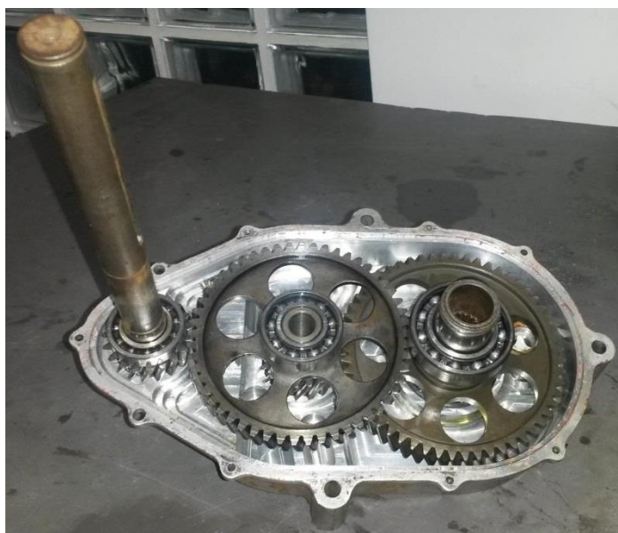
Figura 38 - Caixa de transmissão montada com a engrenagem sinterizada.
