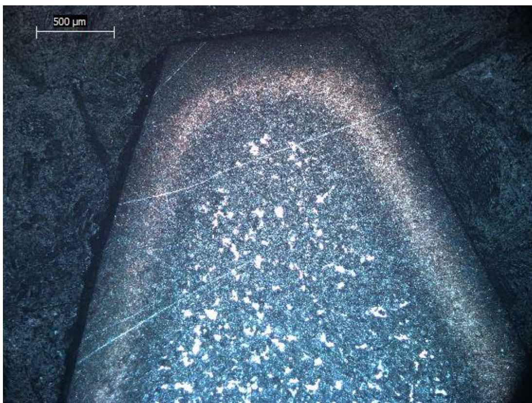
Figura 59 - Análise metalográfica de um dente da engrenagem convencional a um aumento de 50x.
