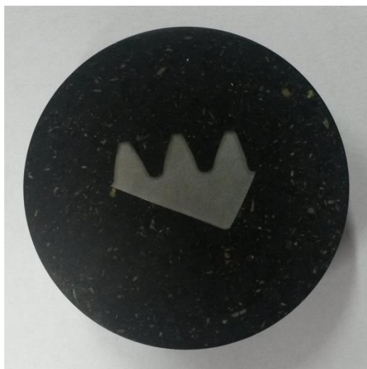
Figura 43 - Amostra de uma das engrenagens preparada para a análise metalográfica.
