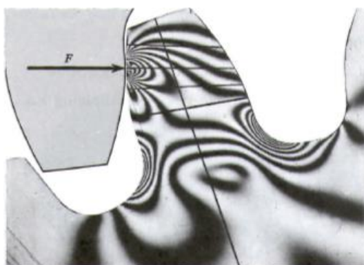
Figura 8 - Ilustração fotoelástica de tensões no dente de uma engrenagem (JUVINALL; MARSHEK, 1991).
