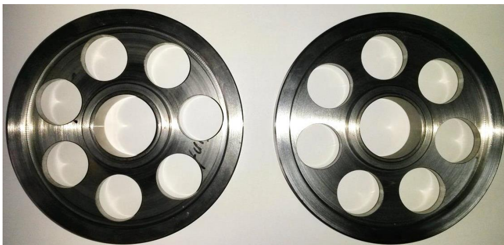
Figura 35 - Engrenagens torneadas e com os alívios de massa fresados (engrenagem sinterizada à esquerda e engrenagem convencional à direita).
