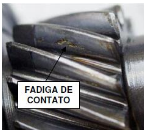
Figura 52 - Trinca visível devido à fadiga de contato (REGO, R. R., 2011).
