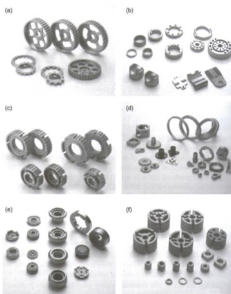
Figura 24 - Aplicações atuais da metalurgia do pó em automóveis: peças de motor (a); peças de sistema de direção (b); peças de sistema de transmissão (c); peças extras (d); peças de amortecedor (e); peças do sistema elétrico de um automóvel (f) (UPADHYAYA, A.; UPADHYAYA, G., 2011).
