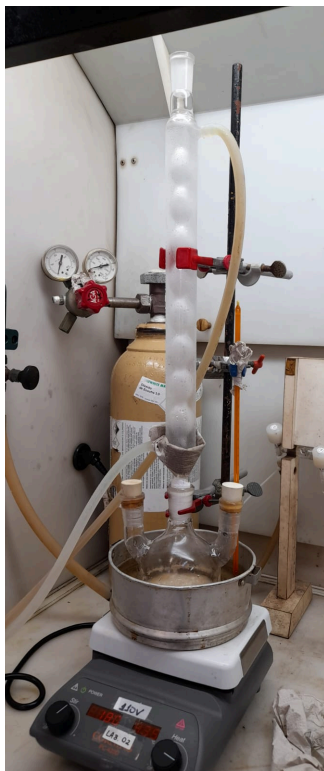
Figura 5. Ilustração do sistema montado para extração do ácido tereftálico a partir do PET com diferentes quantias de base (NaOH).
