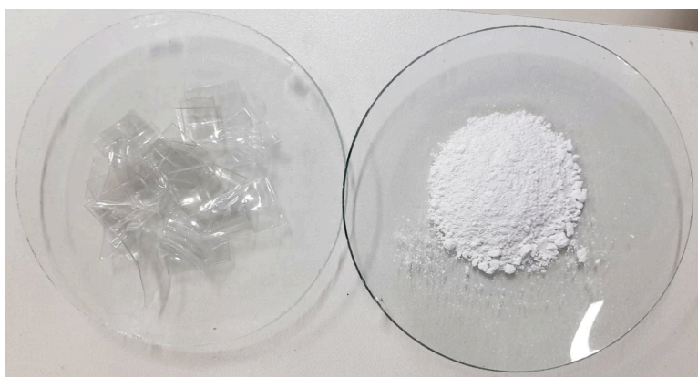
Figura 11. Ilustração da obtenção do ácido tereftálico, sendo à esquerda a garrafa PET cortada antes do processo de digestão e à direita o ácido obtido por refluxo.
