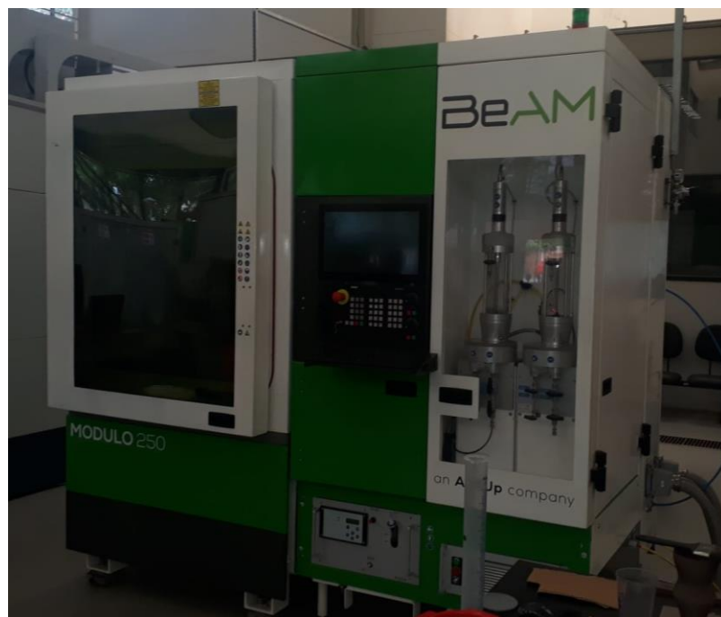
Figura 7 - Equipamento fabricado pela BeAM modelo Modulo 250 utilizado nas deposições
