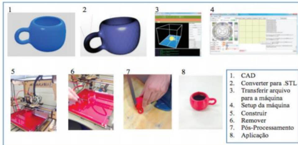
Figura 1 - Sequência de etapas para a fabricação de uma peça por Manufatura Aditiva
