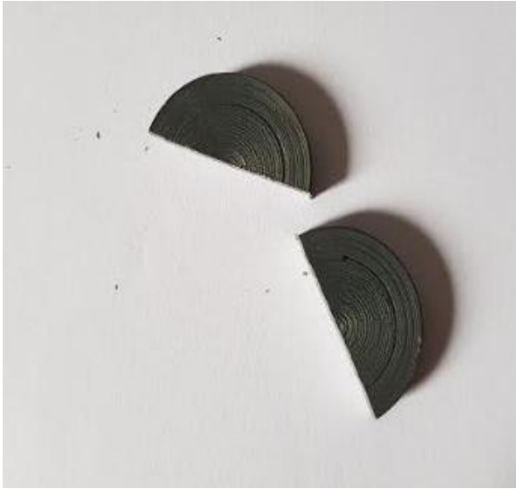
(a) Oxidação a 700°C. Amostra com diâmetro 22mm e espessura 4,4mm.
