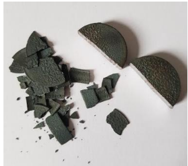
(f) Oxidação a 1000°C. Amostra com diâmetro 22mm e espessura 4,5mm.
