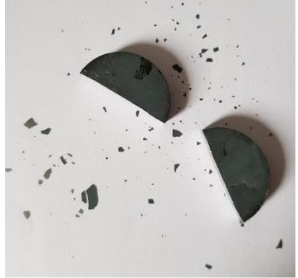
(b) Oxidação a 750°C. Amostra com diâmetro 22mm e espessura 4mm.
