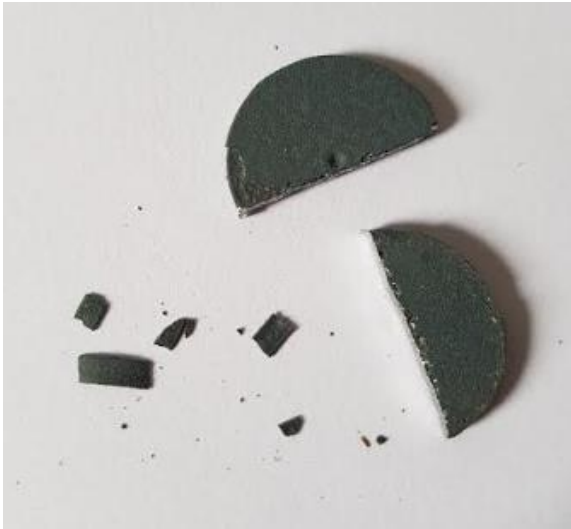
(e) Oxidação a 950°C. Amostra com diâmetro 22mm e espessura 2,4mm.
