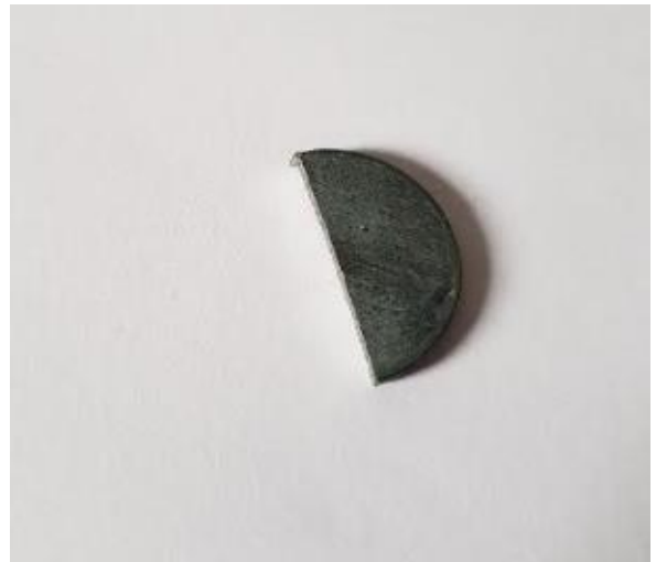
(d) Oxidação a 900°C. Amostra com diâmetro 22mm e espessura 2,1mm.
