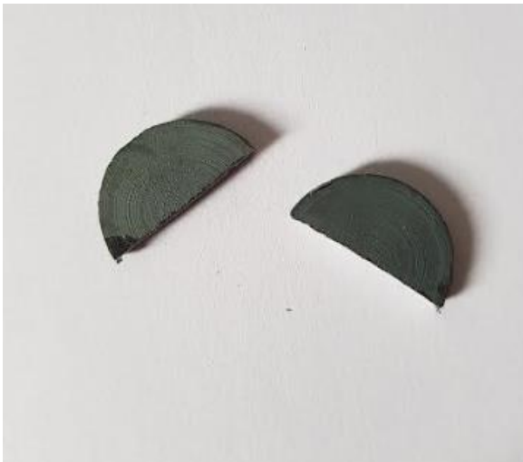
(c) Oxidação a 800°C. Amostra com diâmetro 22mm e espessura 2,3mm.
