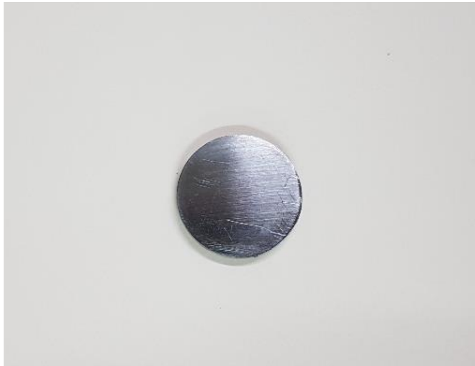
Figura 13 - Vista superior da amostra de aço em formato de disco
