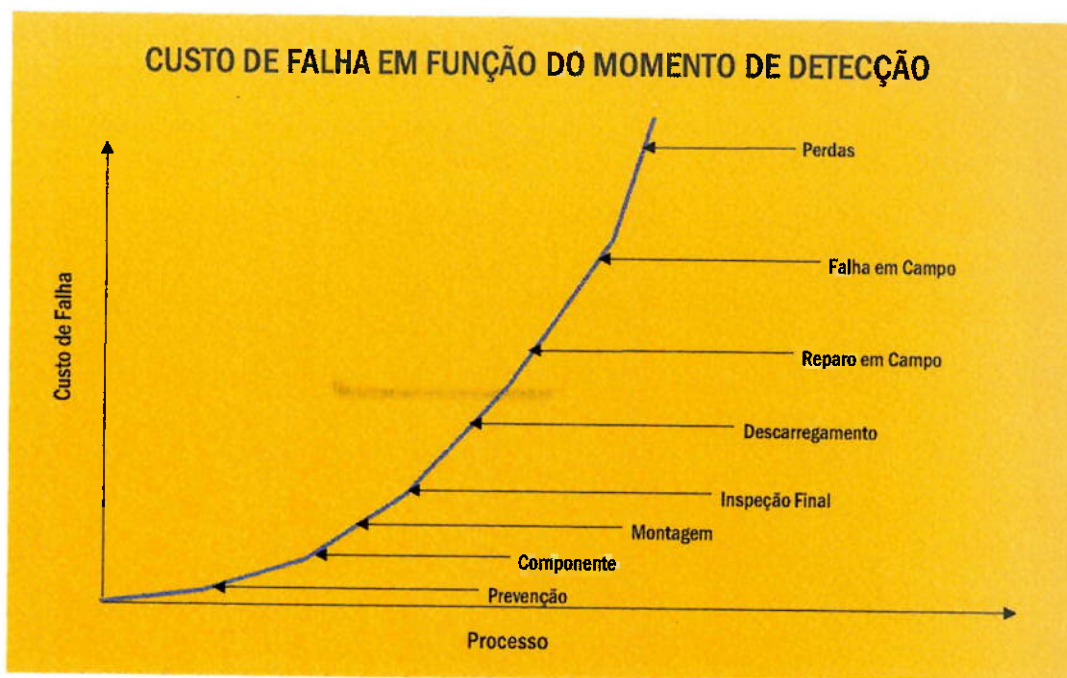
Gráfico 4: Custo de falha em função do momento de detecção Adaptado de: (Campanella - 1990)
