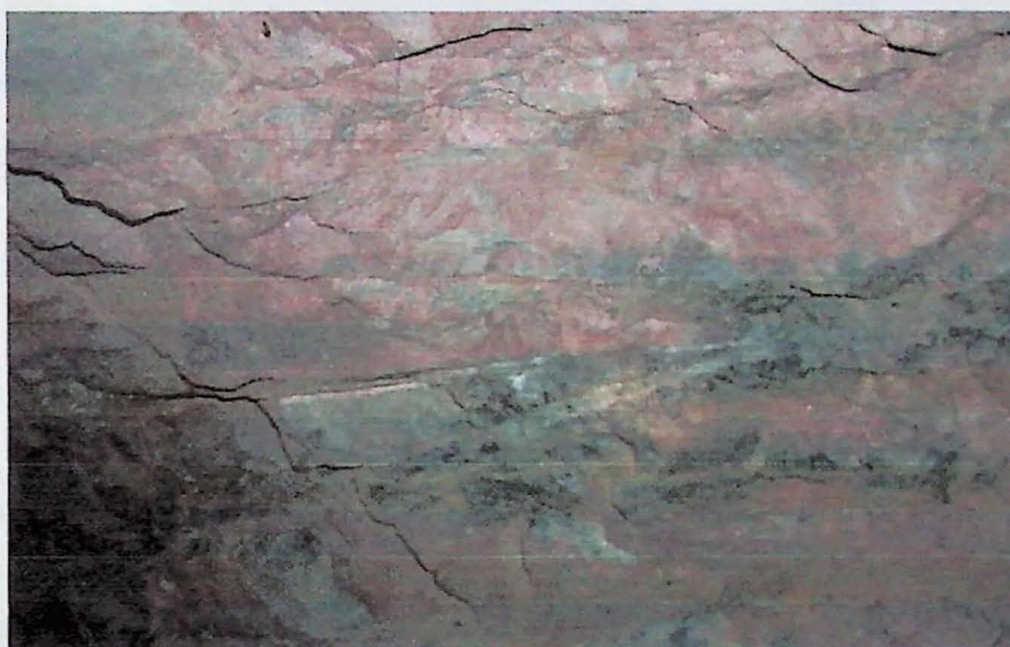
FOTO 3 – Aspecto macroscópico do granito fino vermelho, a principal rocha hospedeira das mineralizações auríferas da Mina do Palito, cortado por veios com alteração propilítica e veios de quartzo cisalhados.
