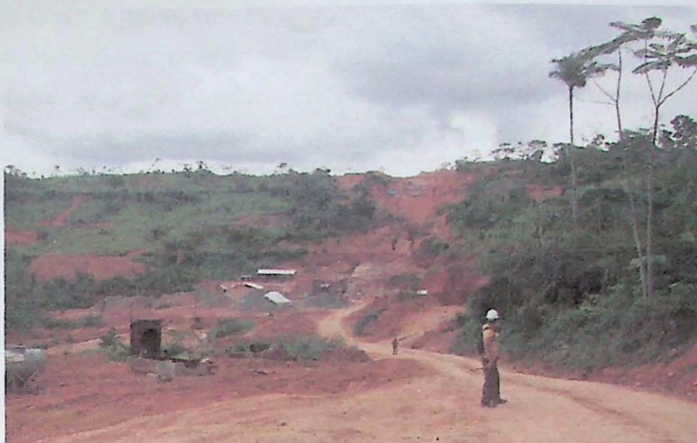
FOTO 1 – Vista geral da área da Mina do Palito, onde podem ser observadas as pilhas de minério lavrados nas galerias subterrâneas, cujas entradas situam-se no sope da elevação, atrás das pilhas.
