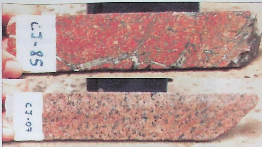
FOTO 4 – Aspecto macroscópico dos granitos Palito (superior) e Rio Novo (inferior) em testemunhos de sondagens.
