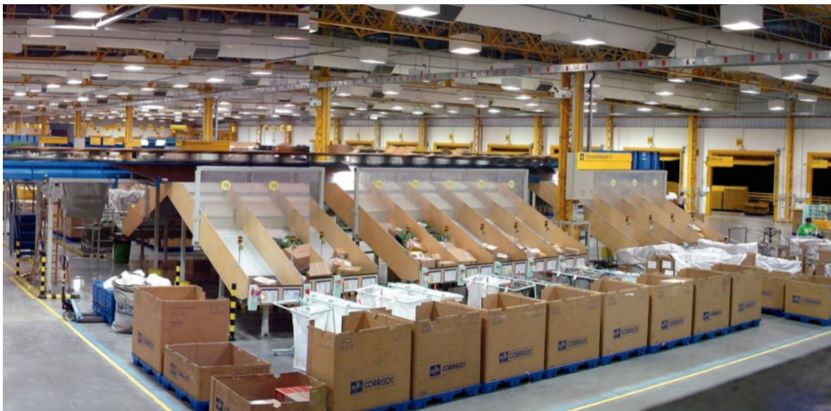
figura 52: Centro de triagem dos Correios. Nota-se as esteiras onde as encomendas são sepa- radas de acordo com o CEP e os CDLS.
