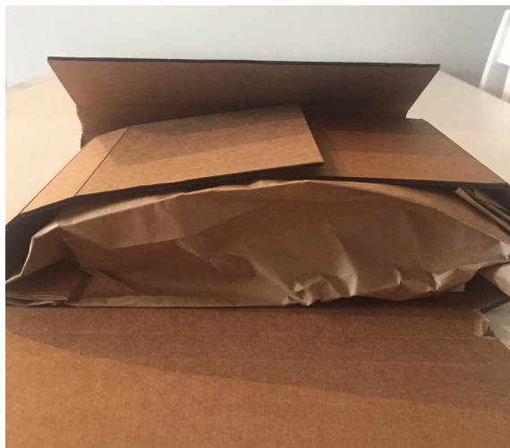
figura 99: Testes com saco de papel kraft fixado no interior da embalagem
