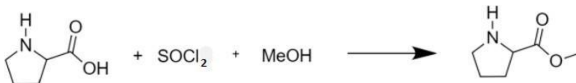
Figura 9: Exemplo da reação de esterificação de aminoácidos (L-Prolina).
