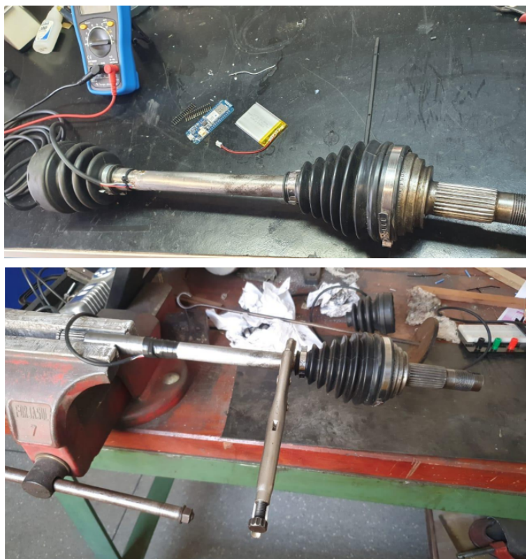
Figura 12 – Instalação e calibração dos sensores
