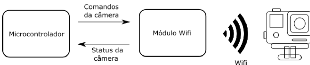
Figura 16 – Atuação do Módulo Wifi como controle remoto da câmera
