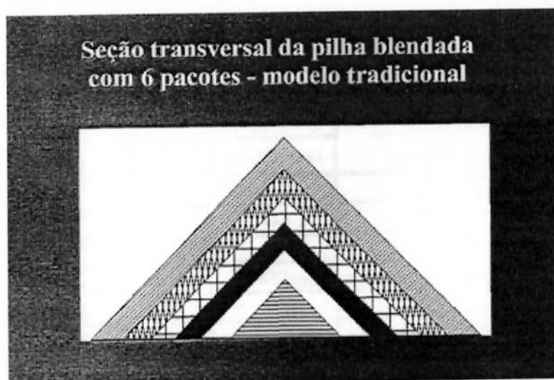
Figura 3: Seção transversal da pilha blendada com 6 pacotes – modelo tradicional
