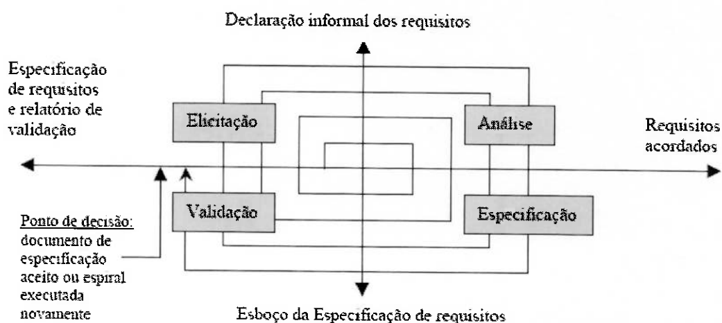
Figura 3 - Modelo Espiral dos processos de Engenharia de Requisitos (KOTONYA 1998)
