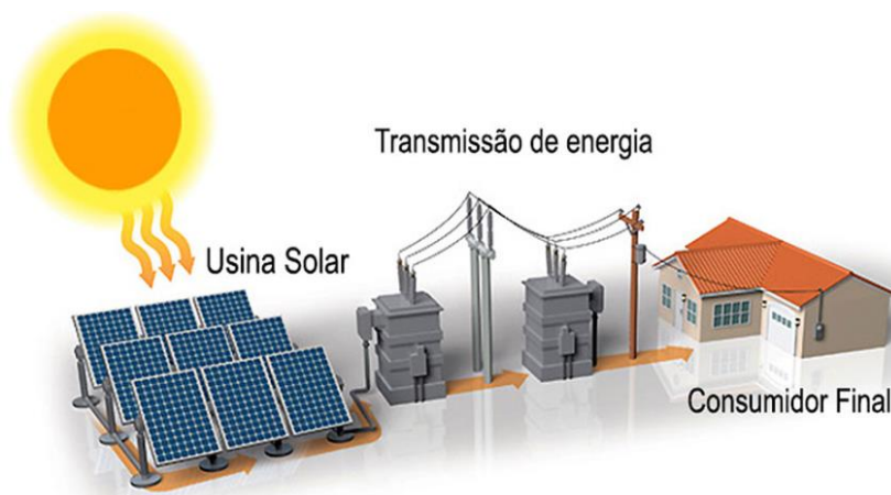
Figura 2.10 – Esquemático da geração na usina solar até a distribuição ao consumidor.
