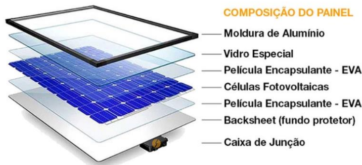
Figura 2.9 – Composição do painel solar fotovoltaico.
