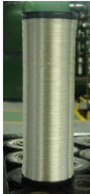
Figura 6 – Carretel com fio pré-torcido (fonte interna)
