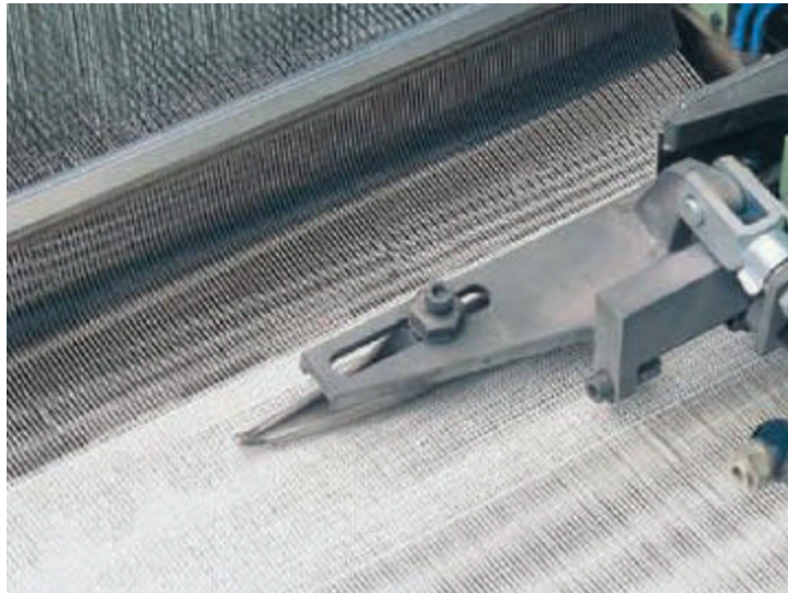
Figura 28 – Fios em um pente de tear (fonte site www.picanol.be )
