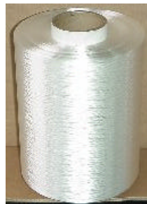
Figura 5 – Bobina ou TBP com fio singelo (fonte interna)
