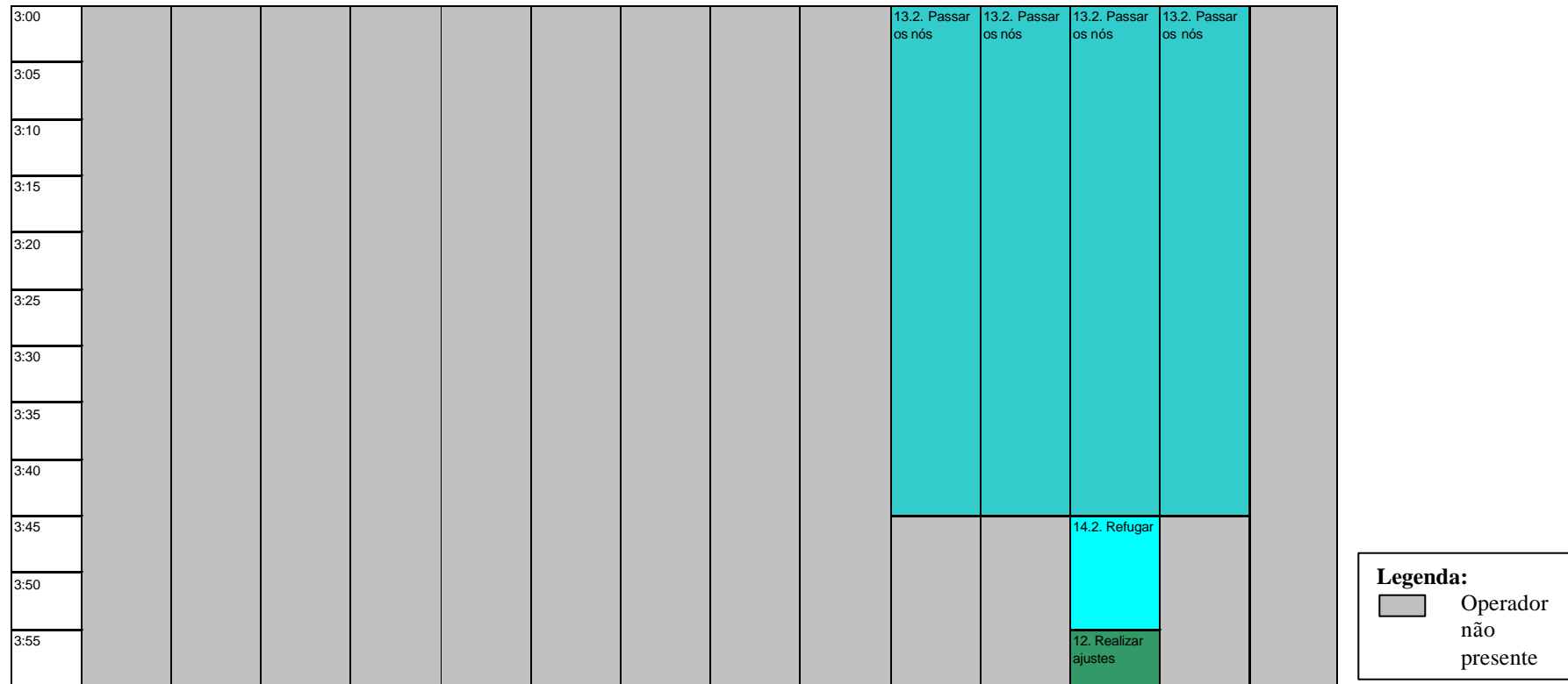
Figura 65 – Gráfico de atividades múltiplas do set-up interno de uma troca de média complexidade – após melhoria (conclusão)
