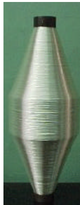
Figura 4 – Cop (ou TBA) com fio singelo (fonte interna)
