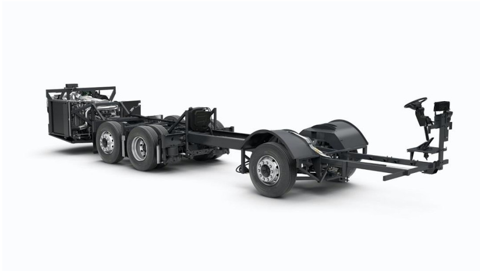
Figura 1 - Exemplo de chassi (Volvo 9700 chassi B13R)
