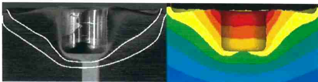
Figura 22. Comparação entre as fronteiras termomecânicas na micrografia da solda com as isothermas obtidas pelo modelo em Forge3. [1]
