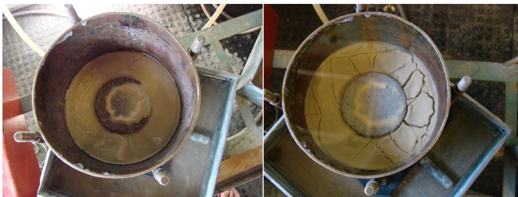
Figura 37: Permeâmetro com o corpo de prova e coberto com bentonita, (a) após aproximadamente 148 horas de ensaio; (b) ao final do ensaio ainda com um pouco de água.
