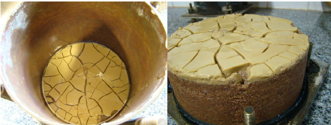
Figura 27: Corpo de prova, após percolar suspensão de bentonita (4g/L), (a) após abrir o permeâmetro; (b) após desmontar o permeâmetro.
