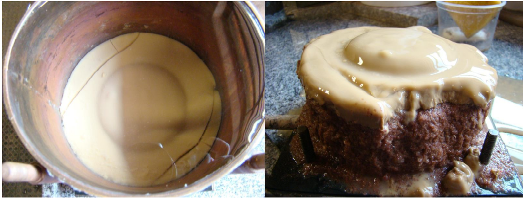
Figura 30: Corpo de prova, após percolar suspensão de bentonita (10g/L), (a) após abrir o permeâmetro; (b) após desmontar o permeâmetro.
