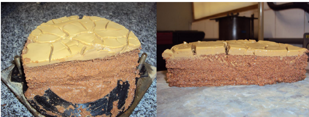
Figura 28: Corpo de prova, após percolar suspensão de bentonita (4g/L), após desmontar o permeâmetro.
