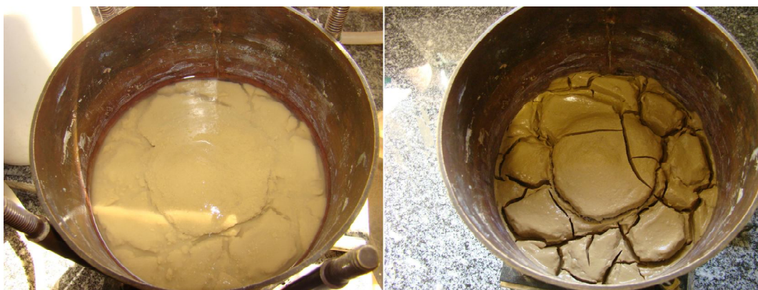
Figura 34: Permeâmetro um pouco antes de ser desmontado, ainda com um pouco de água e sem água.
