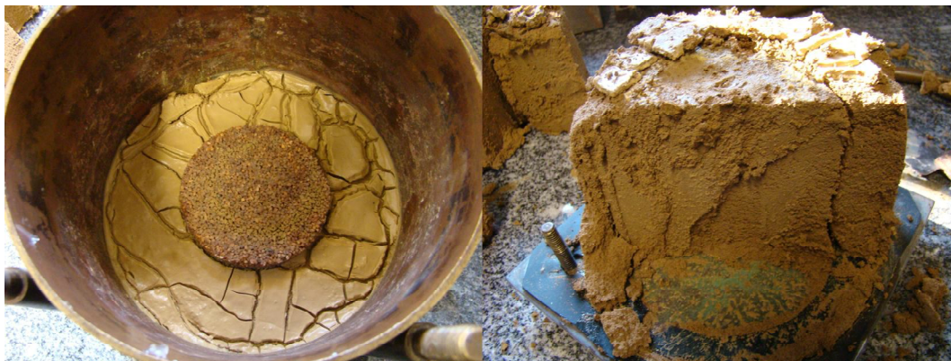
Figura 38: (a) Permeâmetro com o corpo de prova e coberto com bentonita, já sem água (b) corpo de prova após o permeâmetro ser desmontado.
