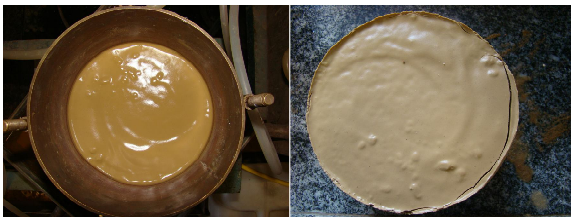
Figura 41: a) Permeâmetro com o corpo de prova e coberto com bentonita, já sem água (b) corpo de prova após o permeâmetro ser desmontado.
