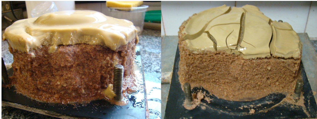
Figura 31: Corpo de prova, após percolar suspensão de bentonita (10g/L).
