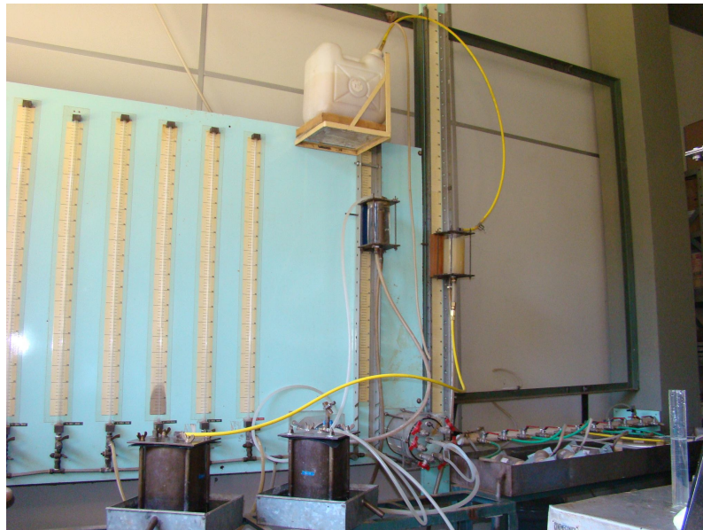
Figura 21: Esquema montado para ensaio com permeâmetros de parede rígida e carga constante, para percolar água e bentonita.
