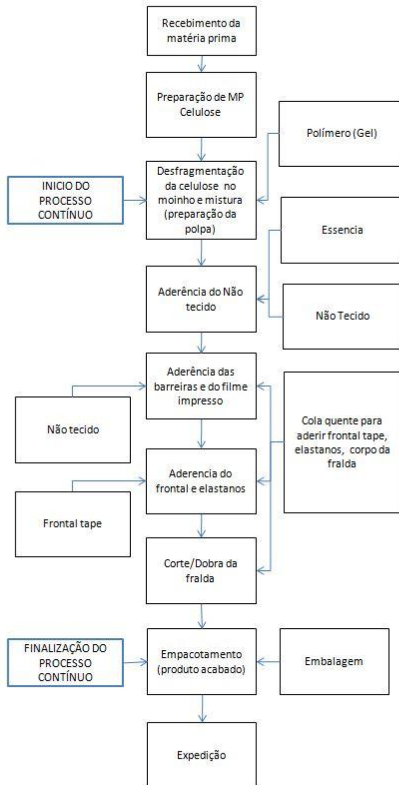
Figura 4 - Fluxograma de fabricação de fraldas Fonte: Elaboração do autor, 2012
