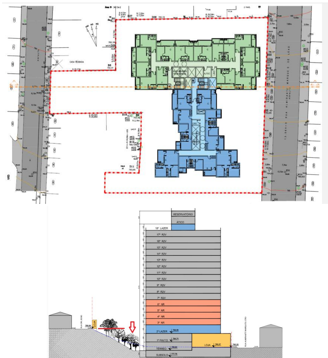
Figuras 44 e 45. Projeto do pavimento tipo e corte esquemático que ilustram a edificação no terreno, assim como os recuos laterais e corte passando pelas ruas Dr. Seng e Almirante Marques leão, evidenciando a diferença de nível 44 . Fonte: Corrientes Empreendimentos Imobiliários LTDA, 2020.
