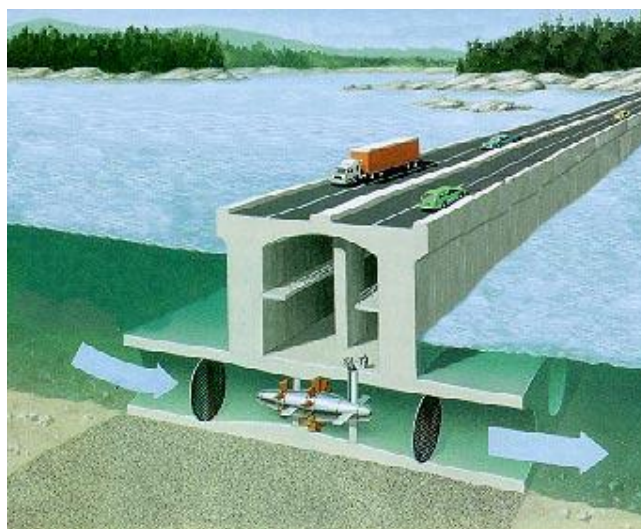
Figura 12. Funcionamento da usina marémotriz – fonte www.portalsaofrancisco.com.br
