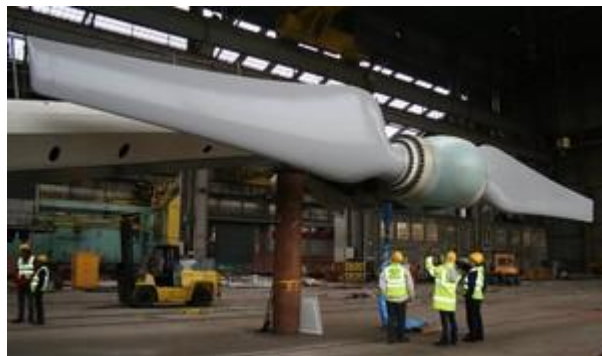
Figura 8. Rotores das turbinas MCT (Fonte: Marine Current Turbines)
